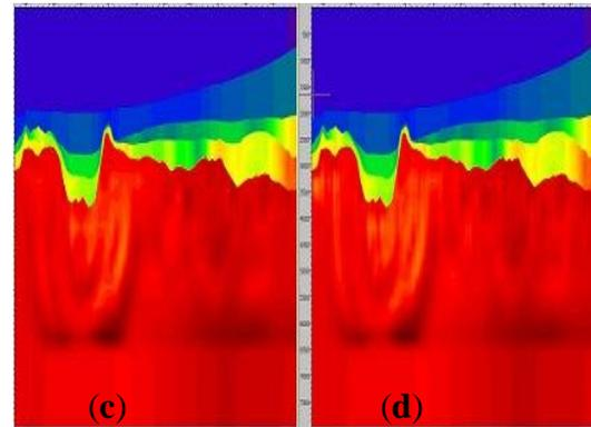
Fig-6 Interval Velocity after 2<sup>nd</sup> (c) and 3<sup>rd</sup> Grid Tomography(d)
